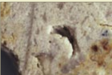
Verder ingezoomd op het snijvlak blijken er verschillende kleine holtes te zijn. Die geven de indruk dat de steen inderdaad gegoten zou kunnen zijn, omdat tijdens zo'n proces makkelijk luchtbellen ingesloten worden.
