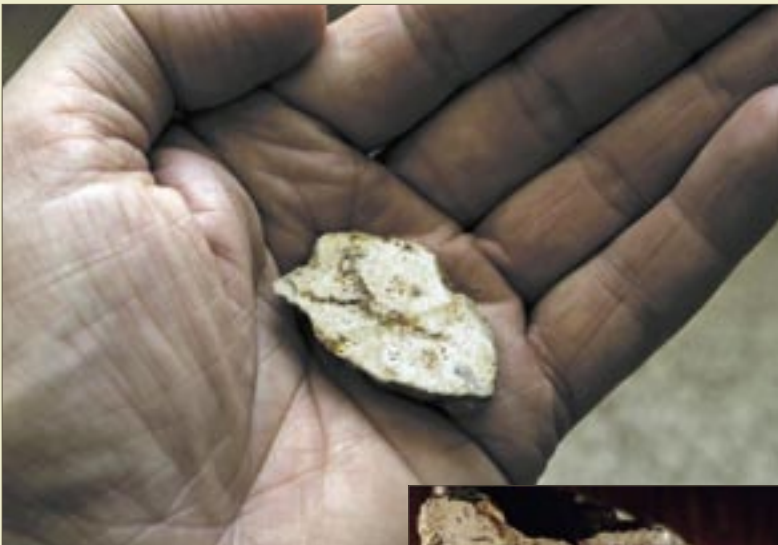
Doorsnede van het kalksteen Cheops monster dat werd gebruikt voor proeven met elektronenmicroscopie en de zogenoemde thin section-techniek.
